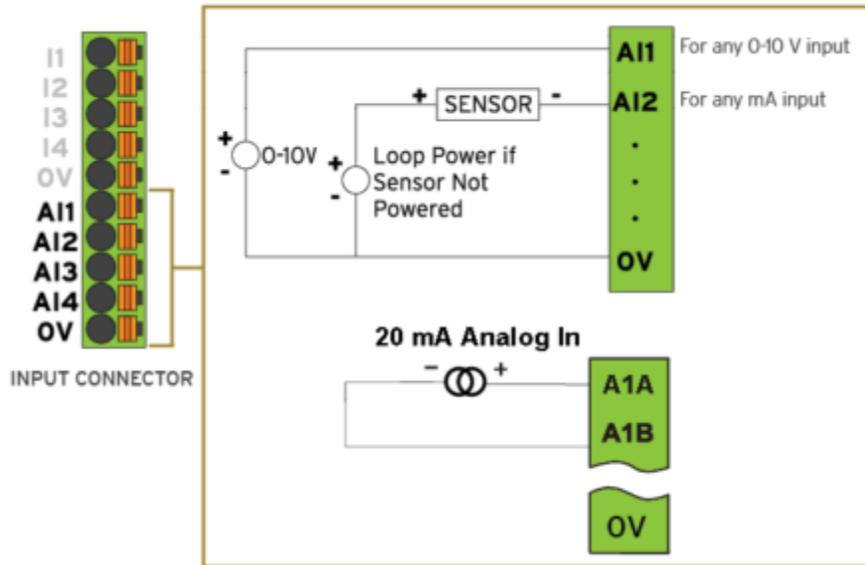
Figure 8.3 - Analog Inputs
